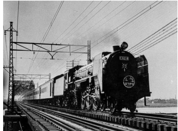
性能的に日本の蒸気機関車の到達点となったC62形 1958（昭和33）年
