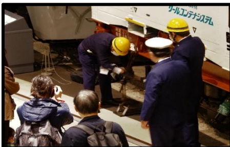
コキ50000形コンテナ貨車緊締具取付の様子
