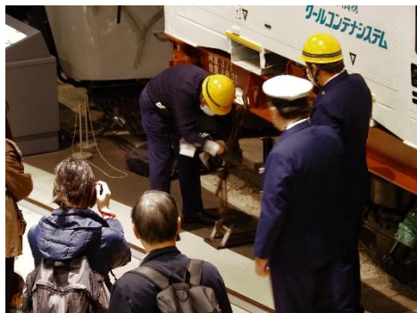
コキ50000形コンテナ貨車緊締具取付の様子
