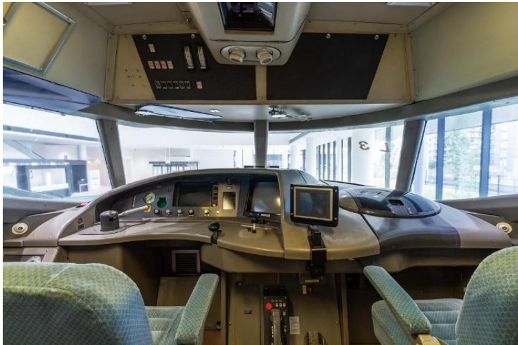
400系新幹線電車 運転室
