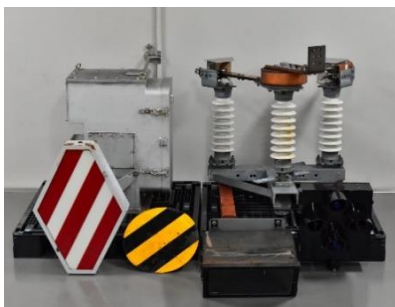
黒磯駅交直切換関係装置・標識類
