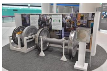
車輪計測・打音検査
