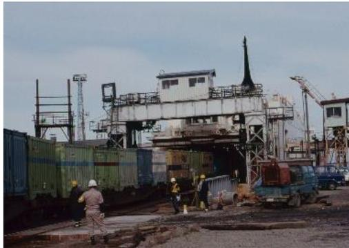
(写真上) 青函連絡船へのコンテナ貨車積み込み
