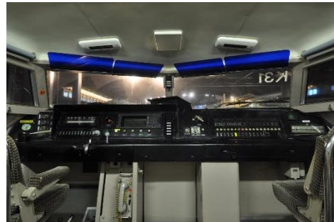
200 系新幹線電車 運転室
